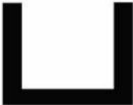
Las representaciones del achurado indican los tipos de materiales de cada una de las piezas y los elementos de sección delgada también se deben achurar. Esto se realiza mediante un ennegrecido del contorno de la sección.
