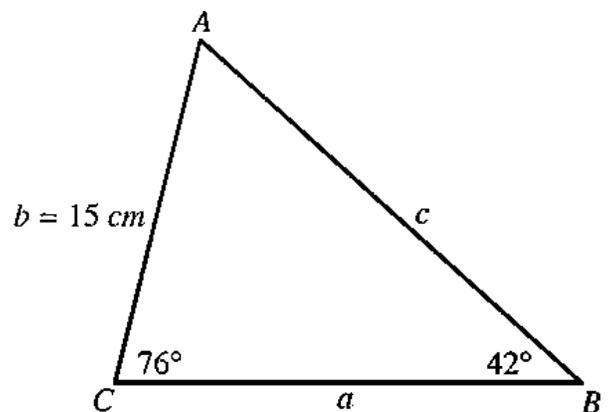
Si observamos, podemos ver que nuestro triángulo tiene dos ángulos y un solo lado, por lo cual podemos aplicar la ley de senos, sin embargo, podemos realizar un análisis sencillo para hallar el otro ángulo desconocido, tomando en cuenta que; la suma de los ángulos interiores de cualquier triángulo debe ser:  $180^\circ$ , la fórmula se ve así:
