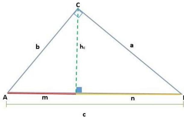
Demostración. Dado un triángulo  $ABC$ , que es rectángulo en el vértice  $C$ , al trazar la altura se generan dos triángulos rectángulos semejantes,  $ADC$  y  $BCD$ ; por lo tanto, sus lados correspondientes son proporcionales:
