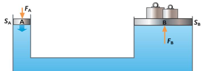
Cuando se aplica una fuerza pequeña sobre el émbolo del cilindro de menor sección,  $S_A$ , se pueden levantar grandes masas colocadas sobre el cilindro de mayor sección,  $S_B$ . Por el principio de Pascal, las presiones en A y B son iguales:  $p_A = p_B$ .
