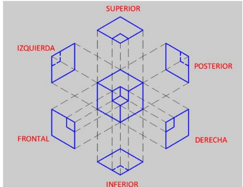
Figura 1. Vistas de dibujo de una pieza
